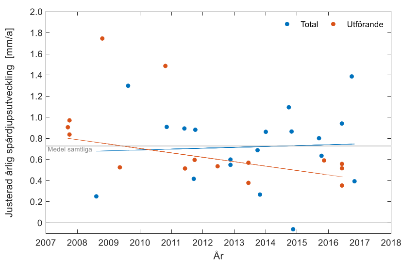
Figur 12. Spårdjupsutveckling för olika kontraktstyper efter trafiköppningsdatum (justerat för årsdygnsmedeltrafik, andel tunga fordon, hastighet och latitud).
