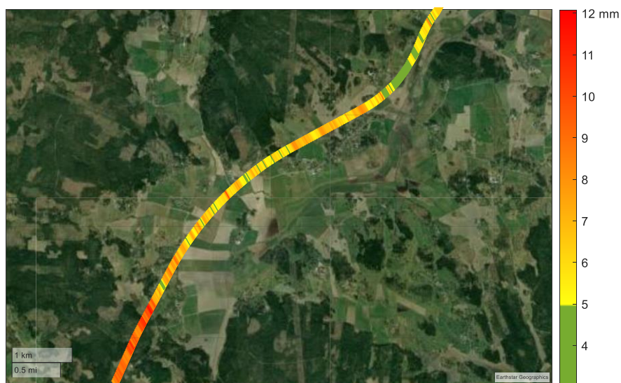
Figur 22. Rumslig fördelning av spår djup längs en väg.
